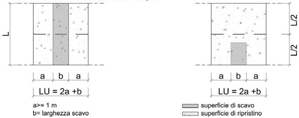
Schema 3.1: scavi trasversali contigui
